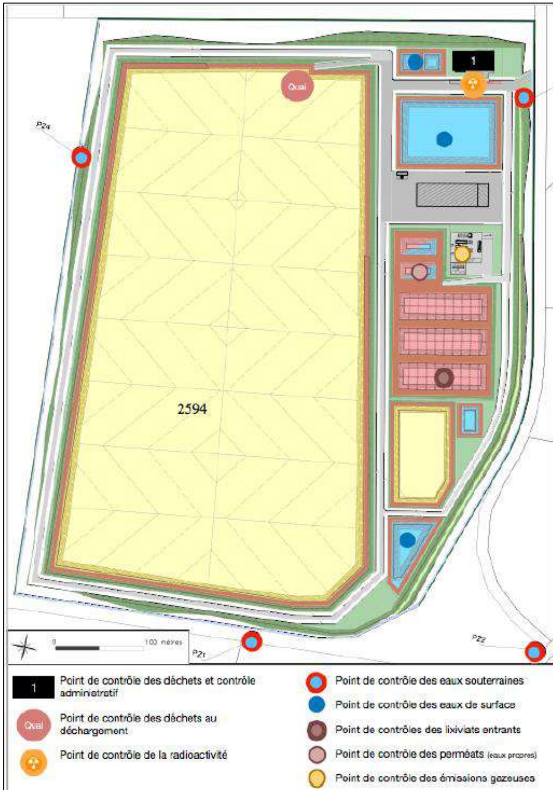
Figure 158 : Plan d'implantation des points de contrôle relatifs au fonctionnement du Pôle Environnemental (Source : Dossier technique)
