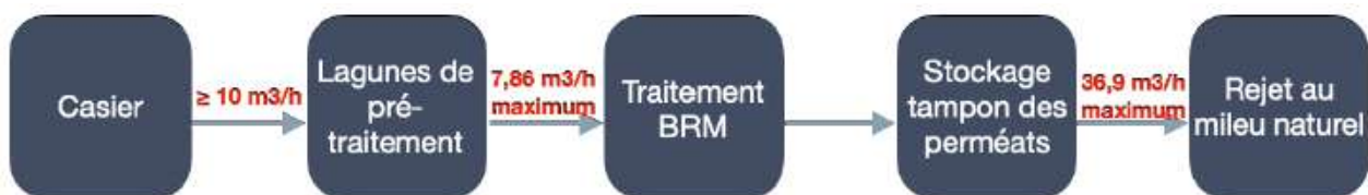
Figure 133 : Synoptique des débits de la filière de gestion et traitement des lixiviats
