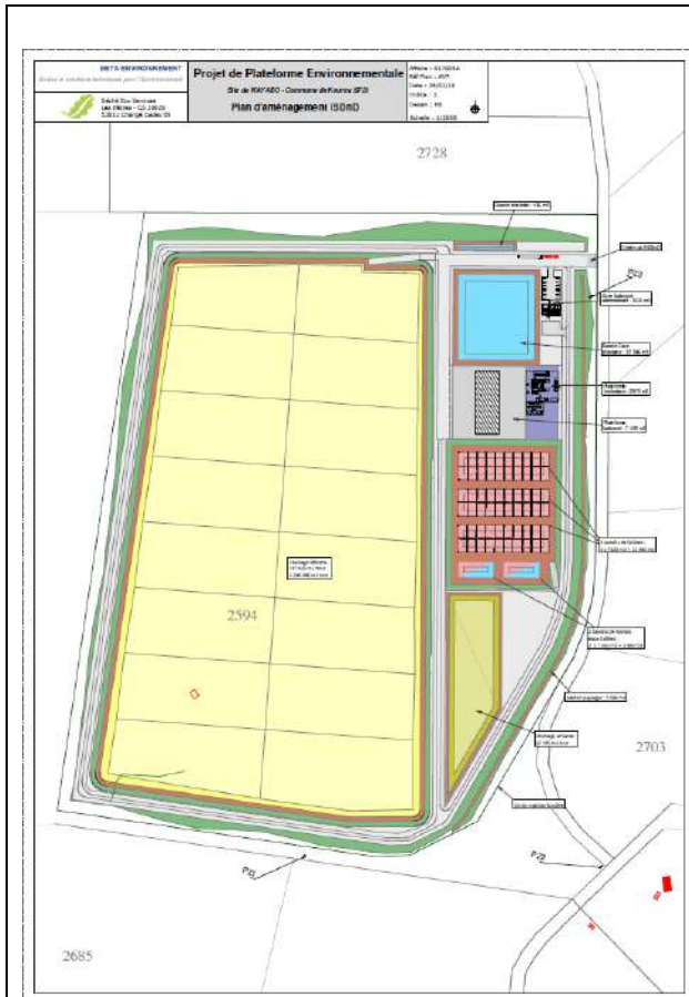
Plan 2.0 : Déplacement du casier DMA, déplacement des lagunes lixiviats vers l'Est, ajout d'un casier pour les déchets de construction contenant de l'amiante liés, mise en place d'un merlon paysager à l'Est
