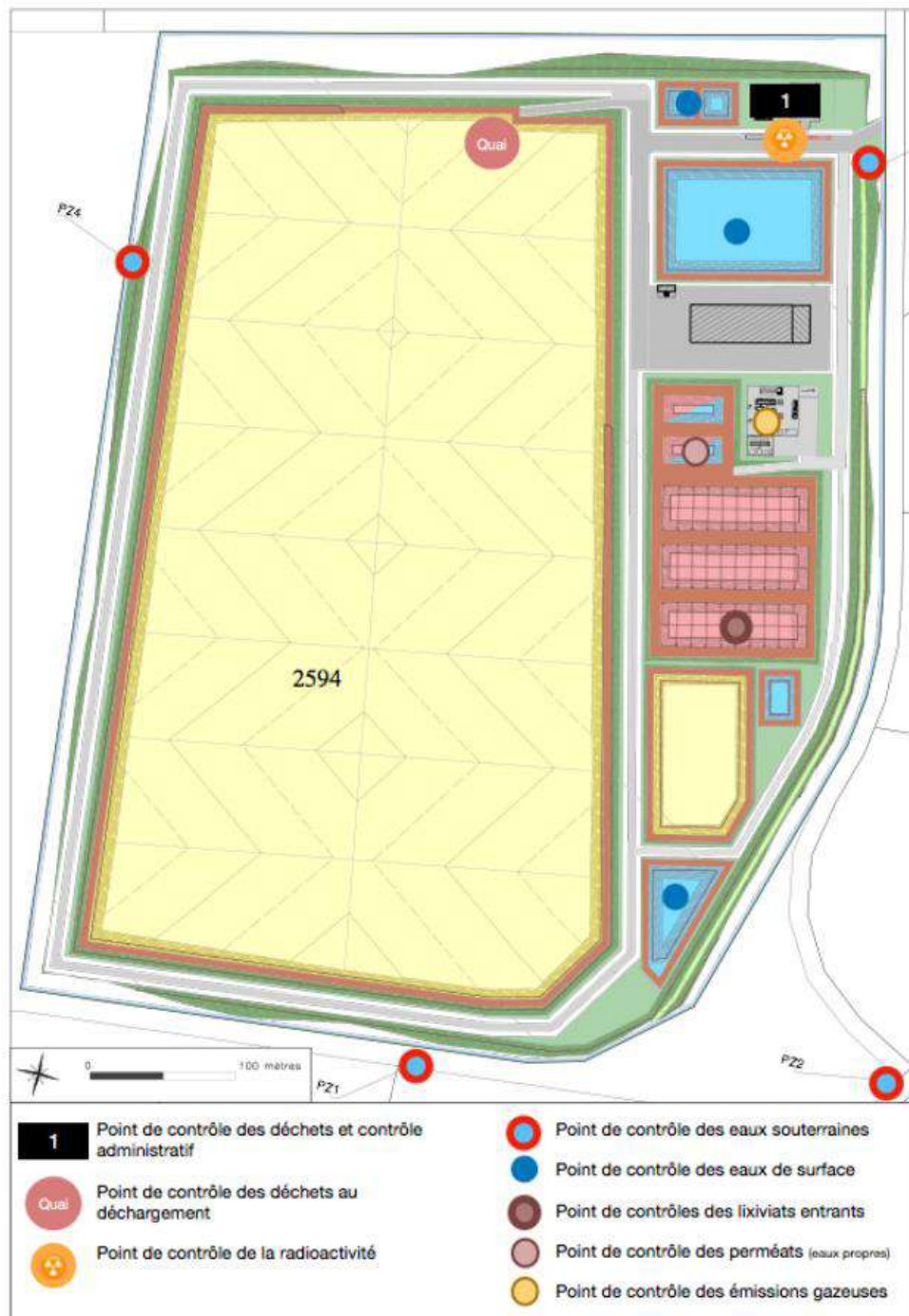
Figure 184. Plan d'implantation de l'ensemble des points de contrôle de l'installation (Source : BETA – Dossier technique)
