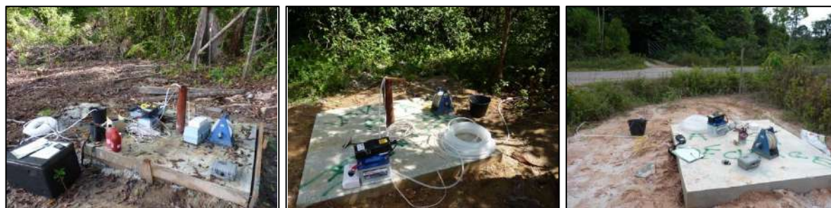
Figure 190. Vue sur les prélèvements d'eau souterraine au droit des piézomètres PZ1 (à gauche), PZ2 (au milieu) et PZ3 (à droite) (Source : ACG – Etude de qualification géologique et hydrogéologique du projet d'ISDND)
