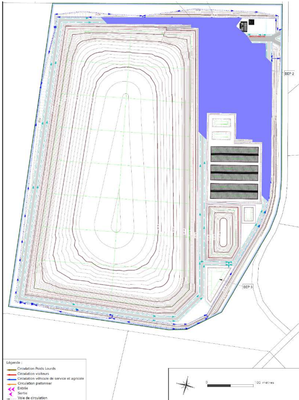
Figure 127 : Localisation de la zone de surverse correspondant à 16 000 m 3 au-delà des capacités des bassins (Source : Dossier technique)
